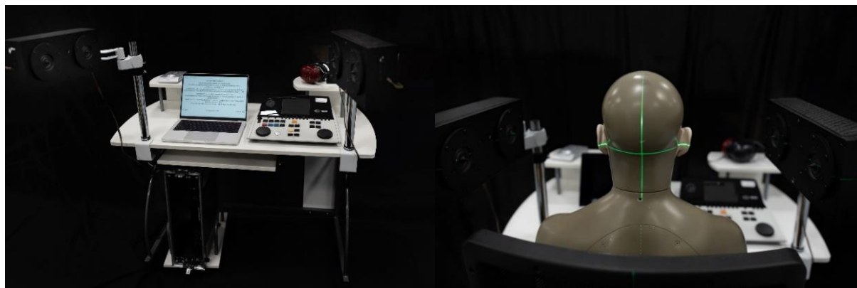
Rys. 5. Mobilne stanowisko do badań oddziaływania hałasu ultradźwiękowego „in situ”.
